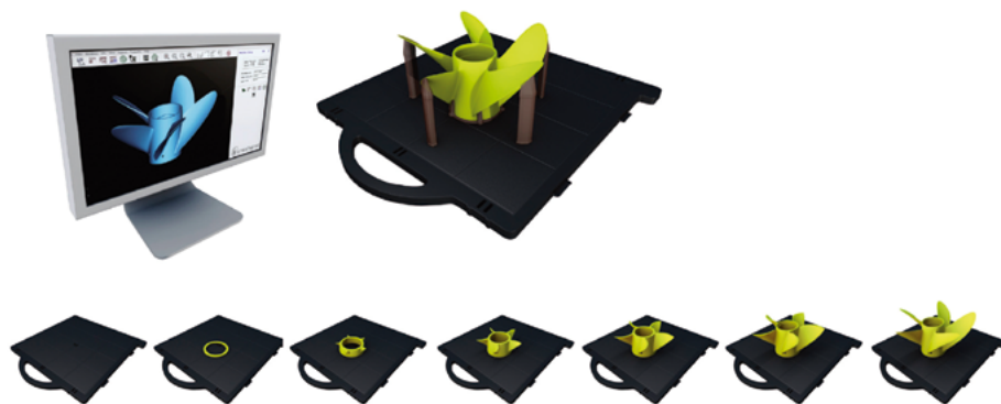
Imagen 2. Secuencia del proceso de modelación digital y fabricación aditiva por capas con la tecnología FDM (Fused Deposition Modeling) de la empresa Stratasys.
