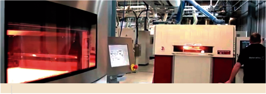
Imagen 19. Máquina de sinterizado selectivo por láser de la empresa 3d Systems. Fuente: 3D Systems, 2015.
