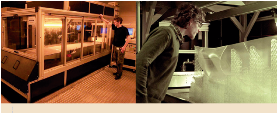
Imagen 6. Máquina de estereolitografía, modelo Mammoth de la empresa Materialise. Fuente: Materialise, 2015.
