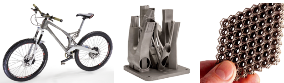
Imagen 26, 27 y 28. De izquierda a derecha prototipo funcional de un marco de bicicleta de la empresa Empire Cycles fabricada en titanio con una máquina marca Renishaw, en la imagen 27(en el centro) se pueden ver todas las piezas del marco fabricado de una sola vez, la imagen 28 es otra pieza hecha con una máquina de la empresa Renishaw, se destaca su complejidad geométrica y definición. Fuente: Renishaw, 2015.
