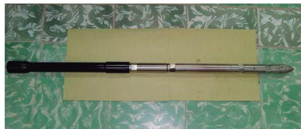
**Figura 7.** Ensamble: Coupling de la bomba de subsuelo – niplesilla perforada – Memoria registradora de Presión
