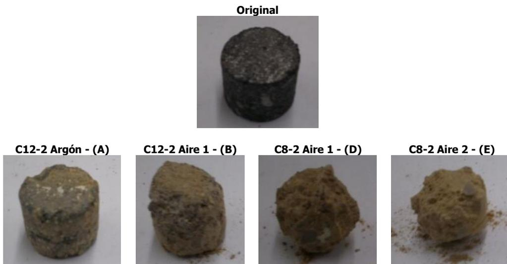
Fig. 7: Probetas original y después de los ensayos.
