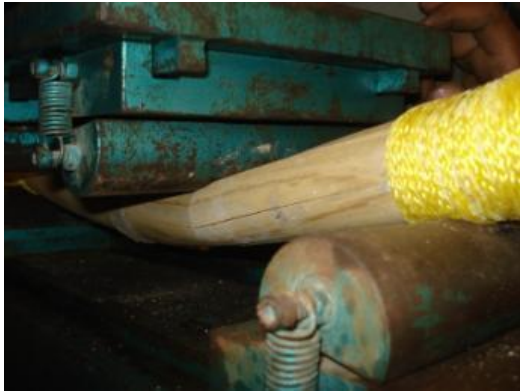
Imagen 13. Cordón de polipropileno en extremos. El momento de la falla el bambú cruje y se aplasta. Fuente: Autor
