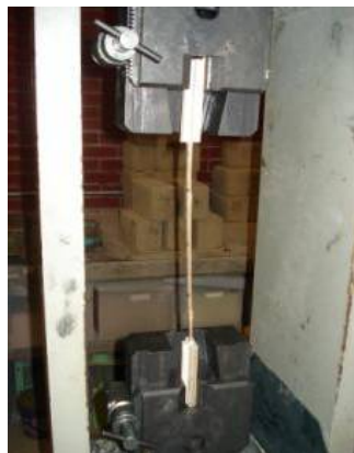
Imagen 11. Sujeci3n de extremos con aditamento propuesto por Arce (1993). Fuente: Autor
