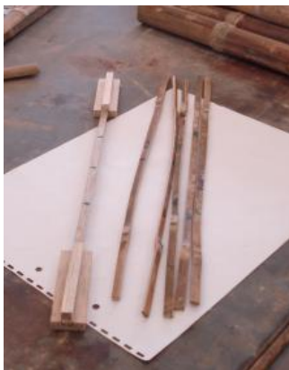
Imagen 10. Probeta con piezas de madera en extremos. Fuente: Autor
