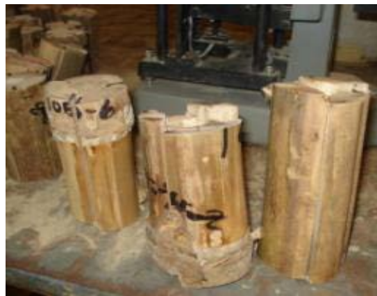
Imagen 8. Falla por corte paralelo a la fibra especímenes con y sin nudo. Se observa el desplazamiento en las fibras longitudinales por efecto del corte. Fuente: Autor
