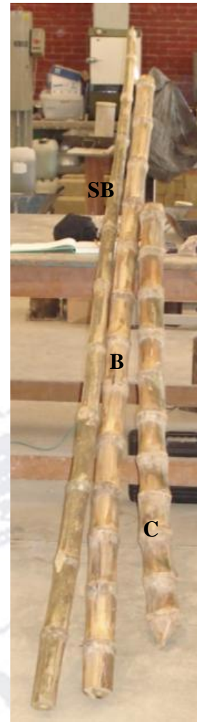
Imagen 4.- Partes ensayadas del culmo de la Guada Amplexifolia. Fuente: Autor
