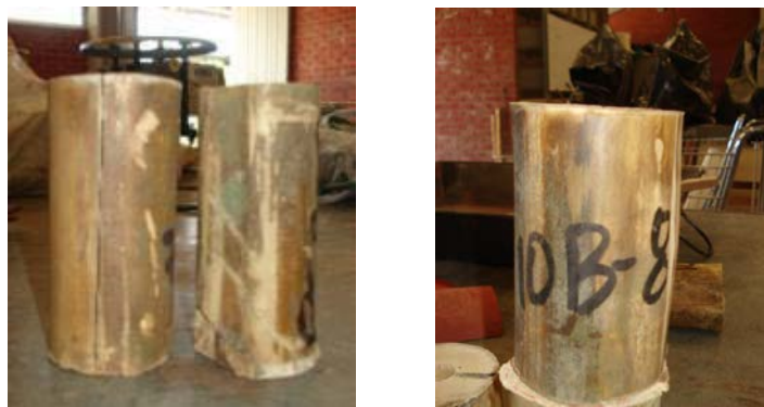
Imagen 6. Falla por cortante paralelo y diagonal a la fibra en las primeras 2 probetas y falla por aplastamiento.
