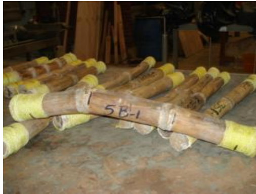
Imagen 14. Probetas ensayadas. El comportamiento es muy distinto a la madera debido a la constitución de sus fibras, en unos casos se presentó cortante longitudinal y aplastamiento. Fuente: Autor
