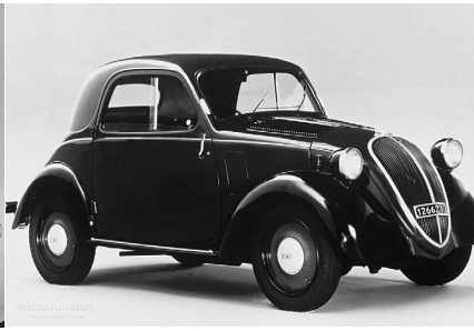
Fiat 500 Topolino de 1936. Obsérvese cómo ha cambiado el diseño de los coches en pocos años. Todo es más redondeado, y tanto la zona de la luneta posterior como la del parabrisas van inclinadas, en vez de verticales, como en el modelo del 32. Los faros siguen separados de las aletas.
