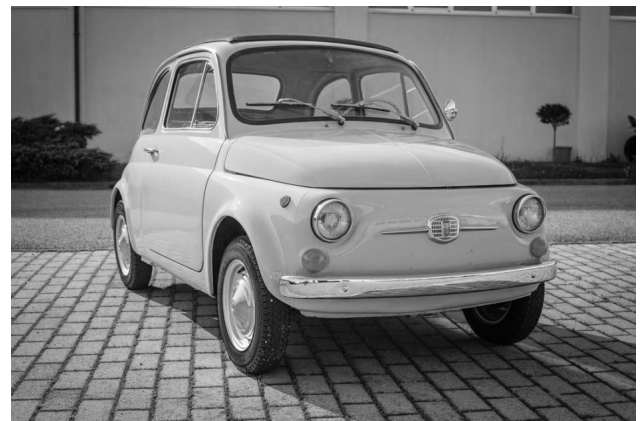
Fiat 500 F de 1965. Parabrisas más grande, puertas con las manecillas detrás y las bisagras delante. Los pilotos delanteros son de color naranja.
