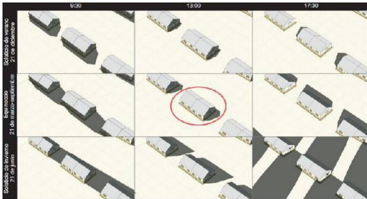
Figura 4. Condiciones de asoleamiento de la vivienda según matriz de 3x3 (variaciones horarias y estacionales). Se observa que la fachada NE se mantiene asoleada durante todo el año en los horarios de mayor radiación solar. Las fachadas con mayor sombra son las E y O. La cara S recibe sol solo en pocas horas de la mañana en verano. Fuente: Elaboración de los autores.
