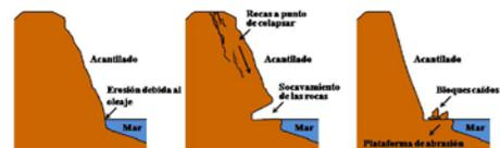
Figura 11. Evolución de un acantilado dando lugar a una plataforma de abrasión. (a) Erosión debida al oleaje. (b) Las olas producen un socavamiento de las rocas. (c) El acantilado colapsa, retrocediendo y dejando expuesta plataforma de abrasión. Fuente: Los autores.
