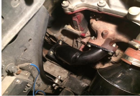
Figura 5. Adaptaciones de admisión y escape adecuadamente montadas
