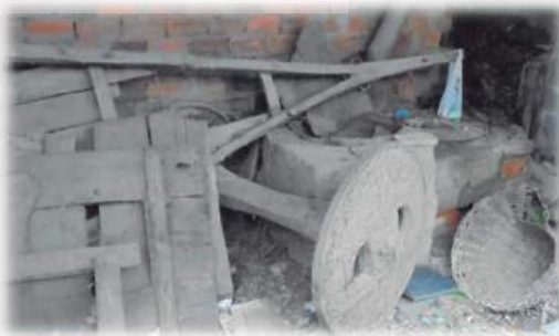
Antigua herrería en la aldea de Nocedo; Se aprecia las ruedas y el eje de un carro fabricadas en madera, así como las llantas de rodadura en pletina de acero (probablemente los animales de tiro serían bueyes).
