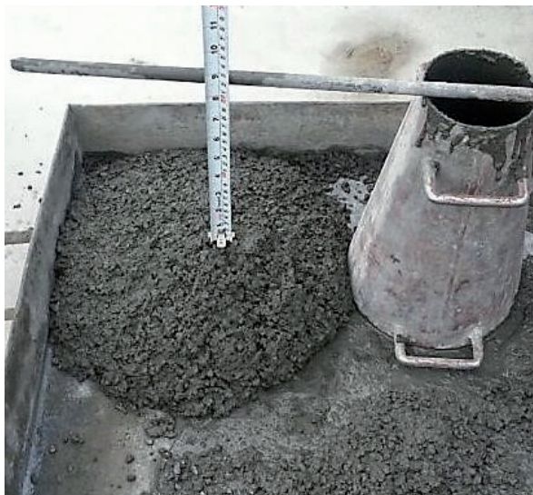
Figura 5. Revenimiento típico en muestras de la mezcla 4.
