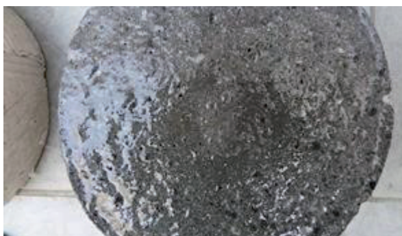
Figura 8. Probeta de mezcla 4 luego del ensayo de erosión abrasión.
