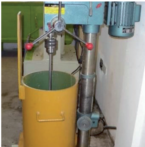
Figura 7. Equipo utilizado para pruebas de erosión abrasión.
