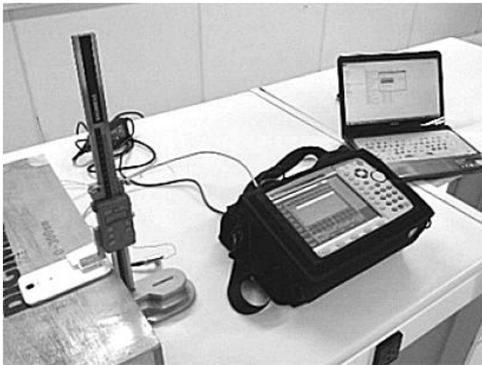
Figura 5 – Estrutura montada para medir o alcance do sinal. Fonte: elaborada pelos autores.
