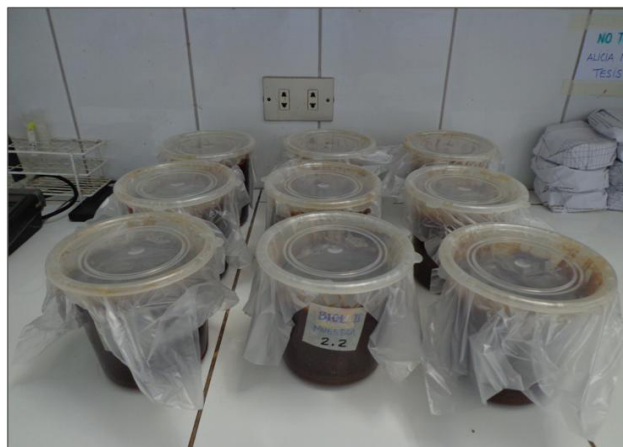
Figura 4. Instalación de nueve biodigestores para el Tratamiento 2.
