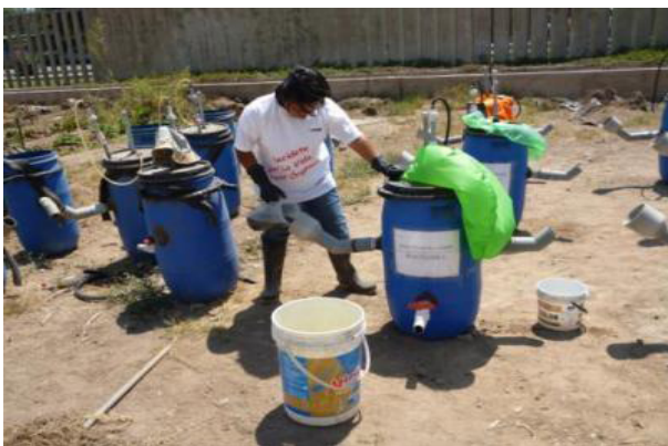
Figura 3. Carga diaria a los biodigestores.
