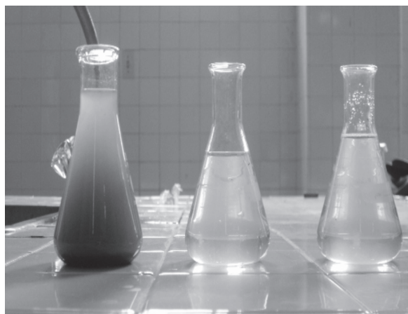
Figura 4. Cambio en la apariencia del agua residual por efecto del tratamiento con el reactor (entrada, mitad y salida).
