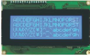
**Figura 6.** Pantalla de cristal líquido, LCD.
