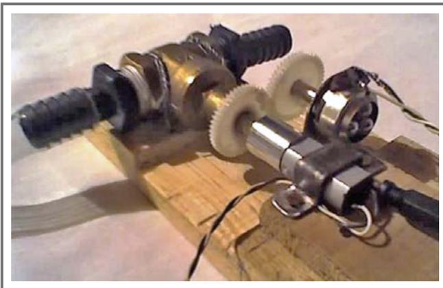
Figura 3. Prueba linealidad potenciómetro multivuelta.
