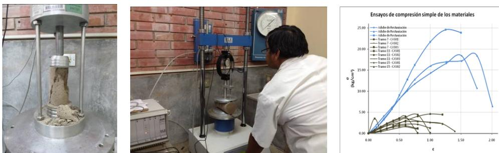
Figura 5. Se muestra los ensayos de compresión y tracción indirecta de cilindros tallados de los adobes hechos con suelo original y también de las muestras del muro original. El gráfico muestra los resultados de ensayos de compresión.
