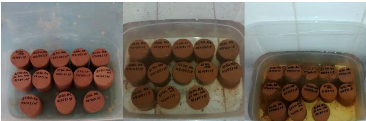
Figura 4. Amostras submetidas ao ensaio de absorção e resistência à água
