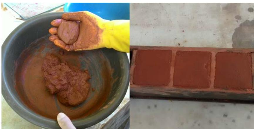
Figura 1. Mistura manual dos materiais e molde cúbico para elaboração dos corpos de prova
