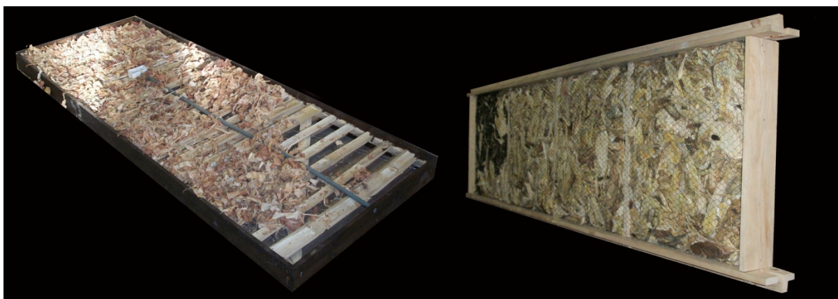
Figura 3 – Imagen del aislante de viruta y pucón
