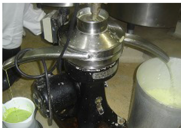
Figura 2. Extracción termomecánica de la fracción lipídica de las emulsiones de aguacate (2ª) y purificación del aceite de aguacate por centrifugación
