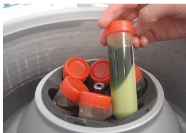
Figura 2. Extracción termomecánica de la fracción lipídica de las emulsiones de aguacate (2ª) y purificación del aceite de aguacate por centrifugación
