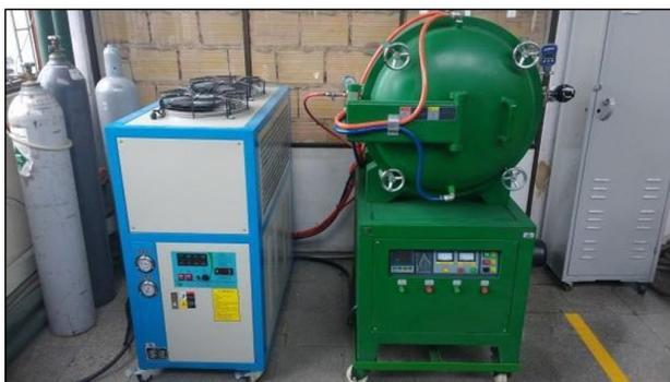
Figura 6. Horno eléctrico de sinterización PT-V1700 34L.
