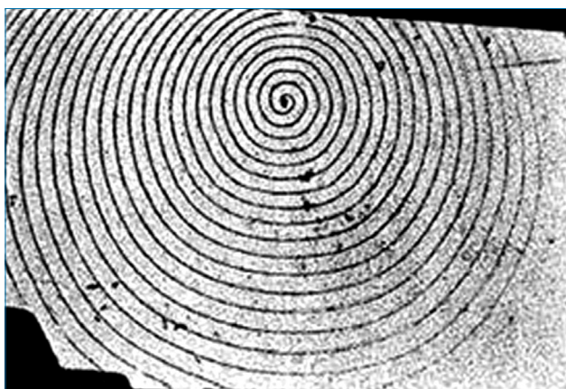
Figura 10. Espiral sobre la superficie de un cristal de SiC, una de las primeras espirales de crecimiento observadas después de la publicación de los trabajos de Burton, Cabrera y Frank. A. R. Verma (1951)
