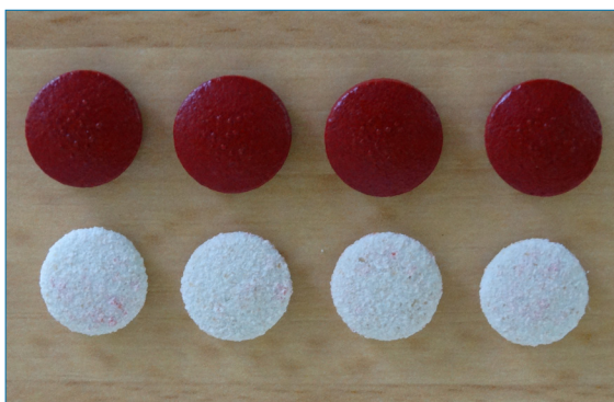
Figura 6. Aspecto de comprimidos de hierro analizados: antes (arriba) y después del lavado con agua
