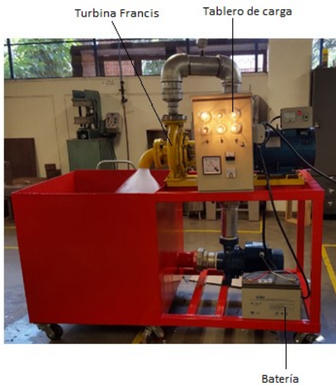
Figura 5. Banco de microgeneración hidráulica con el sistema eléctrico.
