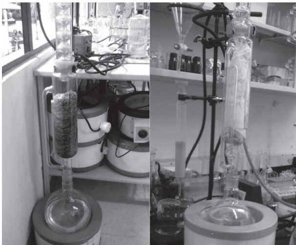
Foto 1. obtención de extractos y fracciones por la técnica Soxhlet (autor)
