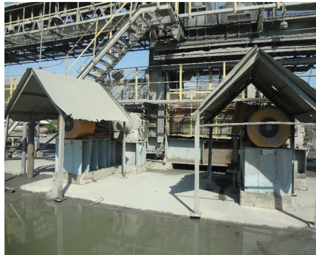
Figura 11. Sistema de accionamiento de una correa transportadora de una mina de cobre al sur del estado de Pará - Brasil. Fuente: Los Autores.
