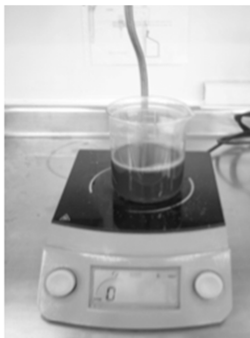
Fig. 3. Montaje experimental para la determinación del punto de ebullición
