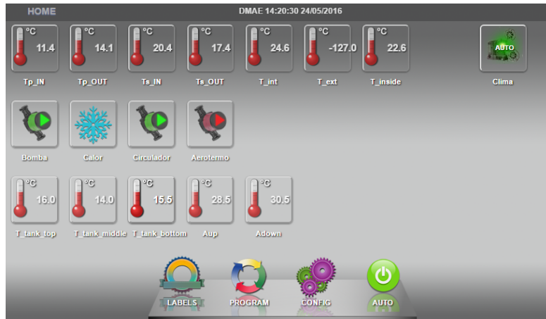
Figura 8. Imagen de la aplicación WEB que permite mostrar en cada momento los valores de los sensores y actuadores.
