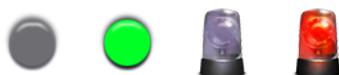
Figura 5. Diferentes iconos para sensores digitales: botón o interruptor sin pulsar y pulsado, alarma inactiva y alarma disparada
