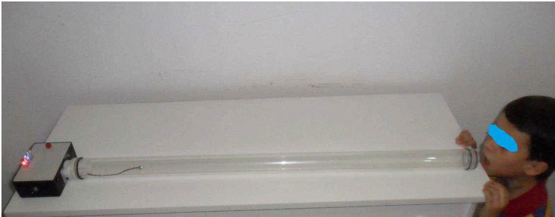
Fig. 6 – Fotografia do aparato eletrônico construído mostrando a luminosidade correspondente às ondas sonoras produzidas pela voz. A criança é filha de um dos autores e está apenas representando por onde o som é emitido. Fonte: elaborada pelos autores.
