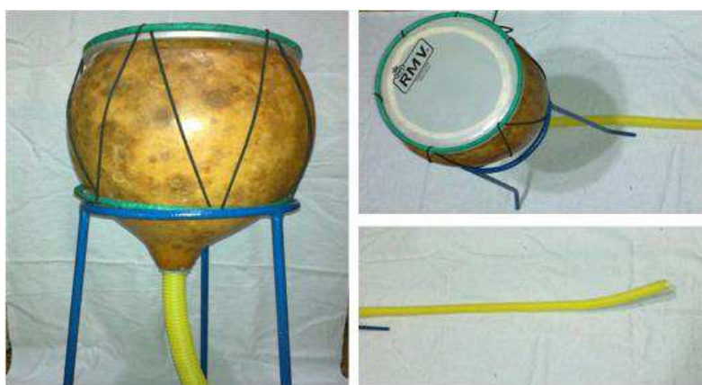
Fig. 3 – Dispositivo para permitir que se possa ter uma percepção visual de uma onda sonora. Fonte: elaborada pelos autores.
