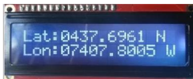
Figura 3. Visualización datos obtenidos GPS Latitud y Longitud LCD 16x2 (Fuente: Propia)
