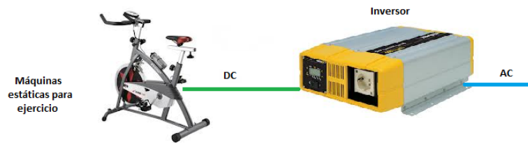
Figura 3. Sistema de generación distribuida en base a bicicletas estáticas conectado a la red [14].
