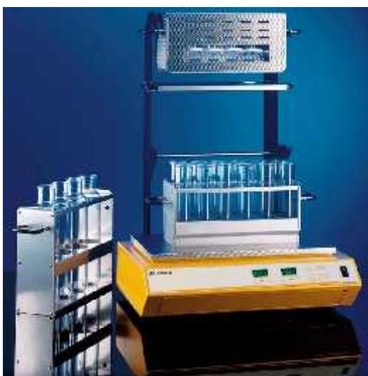
Imagen 1.1 Sistema de digestión tipo Kjeldahl
