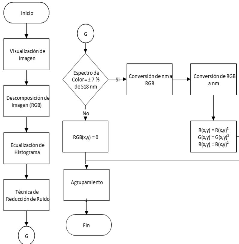
El diagrama muestra la secuencia de pasos utilizados desde la adquisición de la imagen y todos los pasos del procesamiento para la detección de fluorescencia.
