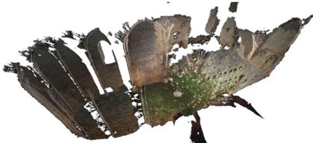
Figura 20. Nube de puntos coloreada con la imagen esférica capturada por la cámara interna del escáner
