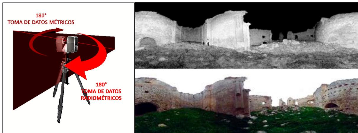
Figura 14. Esquema de las fases de captura de escáner. A la derecha podemos ver la imagen plana en grises de la toma de datos métricos y la imagen a color de la toma de datos radiométricos
