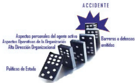
Figura 11. Modelo de seguridad sistémica de J. Reason. Cada ficha corresponde a un aspecto que, al no estar debidamente controlado, impacta sobre el siguiente, hasta generar el evento adverso o el accidente. Véase Reason 1990.
