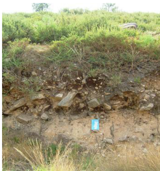
Fig. 5 - Heterogeneidade dos materiais constituintes do depósito de Soutelo de Matos. Fonte: B. MARTINS, 2010.
