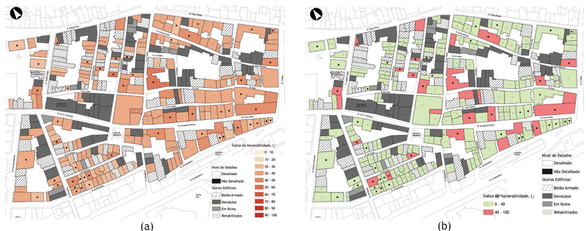
Fig. 3 - Mapeamento do índice de vulnerabilidade I_v para o Bairro Ribeirinho de Faro (a) e identificação dos edifícios com I_v > 40 (b).
