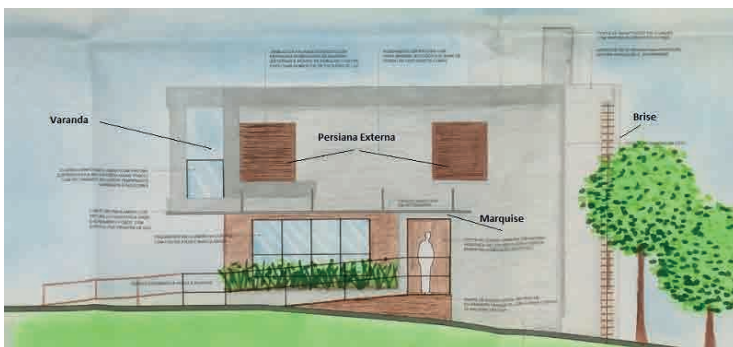
Figura 6. Imagem da fachada lateral nordeste de uma das residências projetadas com soluções arquitetônicas de controle solar – ECS nas aberturas: varanda, persianas externas, brise, marquise. Fonte: Desenho dos autores.
