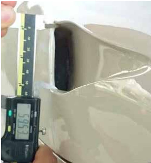
Figura 3. Medidas de la toma NACA Scoop. Fuente: autores.
