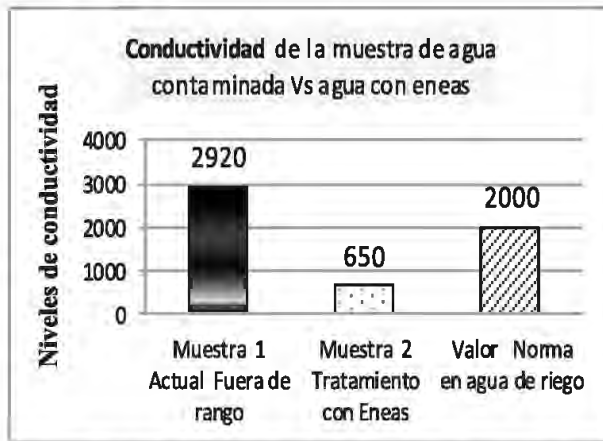
Figura N° 07. Los valores altos de conductividad es un indicador del contenido de sales disueltas o de minerales del agua (mineralización); se estabiliza en a los 7 días de instalado el sistema de purificación de humedales.
