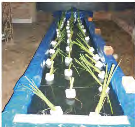
Figura N° 02. Sistema de flotación por Humedales "Proyecto de purificación de agua residual para riego - Universidad Cesar Vallejo - Chiclayo"
