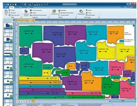
Figura 4: CAD 2D Audaces, específico para o encaixe de moldes do vestuário.
