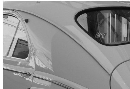
En el Peugeot 203 del reportaje (1950) el vierteaguas se prolonga hasta la tapa del maletero. (Fotografía: Miguel Ángel Fuertes Manjón)
