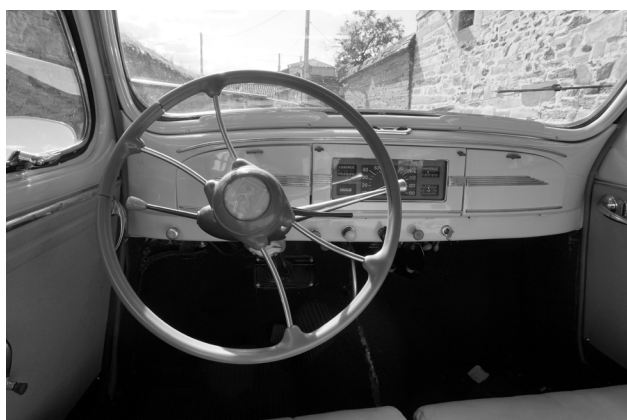
En el Peugeot 203 del reportaje (1950) el velocímetro está en el centro del salpicadero como en los modelos de los primeros años de producción, y el volante es de cuatro radios. (Fotografía: Pablo Pérez García)
