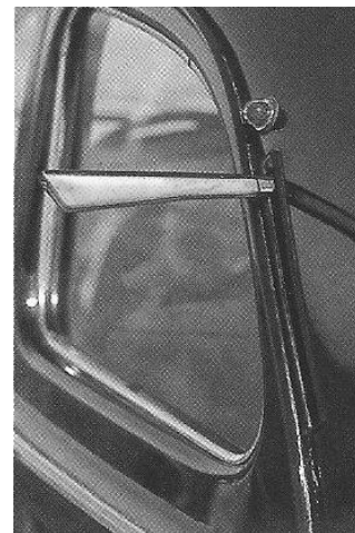
Flecha de dirección de un 203 de 1955. (Fotografía de J. F. Pacheco, Motor Clásico n° 140, p. 17)
