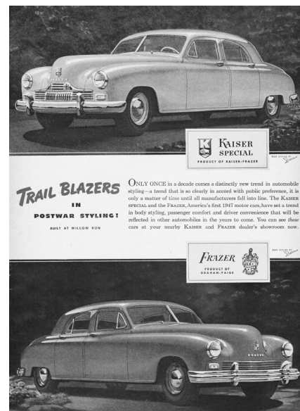
Publicidad del Kaiser-Frazer de 1947. Este vehículo, presentado en 1946, fue el primero de la historia del automóvil en eliminar las aletas diferenciadas, dejando los laterales lisos. Las carrocerías que en los años siguientes tomaron esta característica fueron denominadas “carrocerías pontón”. (Imagen tomada de Internet: www.oldcarmanualproject.com )
