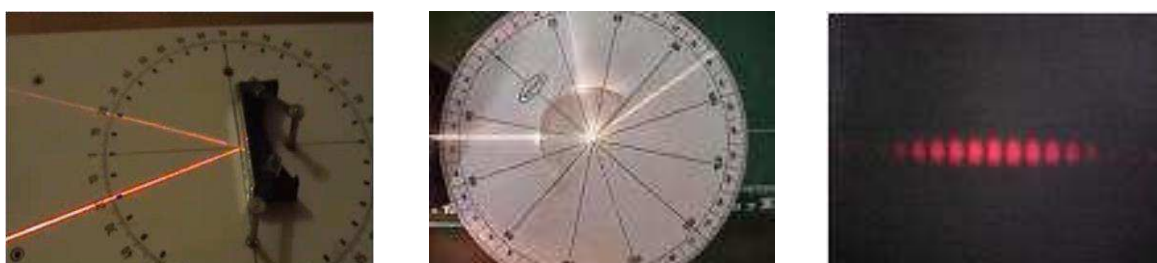
Fig. 1 – Izq.: Imagen de la experiencia de la reflexión, factible de ser realizada en clase; Centro: Imagen de la experiencia de la refracción factible de ser realizada en clase; Der.: Imagen del resultado obtenido en la pantalla al realizar la EDR utilizando un puntero láser color rojo, y dos ranuras finas realizadas en una lámina de aluminio.
