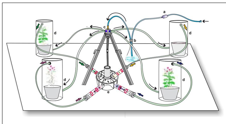
**Figura 1.** Ilustración del olfatómetro de flujo de aire de cuatro vías: a) línea de alta presión de aire (compresor) y filtro de carbón activado; b) trampa de agua; c) repartidor; d) cámaras colectoras; e) cámara principal. Las flechas indican el recorrido del aire (dibujo digital por C. Pinto).
