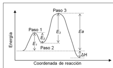
Figura 6. Diagrama de energía potencial para un mecanismo de tres pasos en el sulfonador de ME con \text{SO}_3 , en el cual el tercero es el que determina la velocidad de reacción
