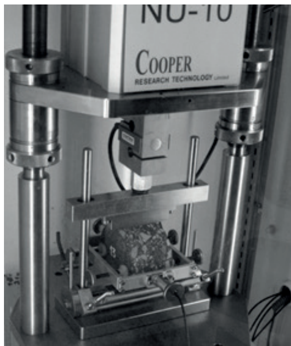
Figura 1. Equipo NAT en una prueba de módulo de rigidez.
