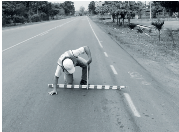
Figura 4. Medición del ahuellamiento en la vía E - 25.
