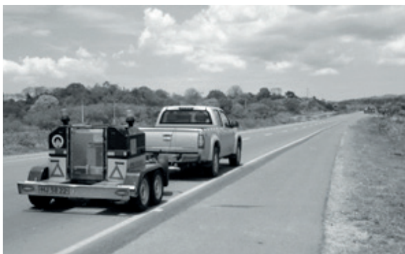
Figura 2. Medición con equipo FWD en la vía "Progreso-Playas".
