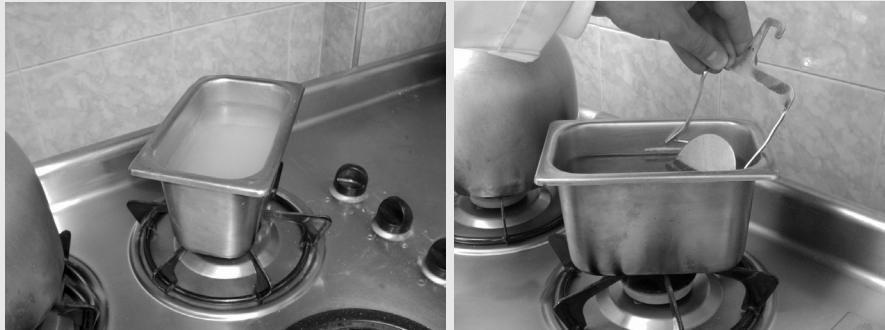
FIGURA 1. TEST DE EBULLICIÓN. A LA IZQUIERDA NaCl EN EBULLICIÓN Y A LA DERECHA LENTE EN EL PORTALENTE SUMERGIDO A LA MITAD
