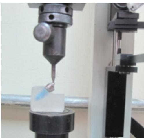
Figura 16. Aplicación de carga en piezas dentarias.
