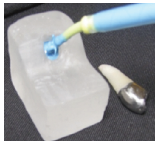
Figura 15. Colocación de silicona en el lecho del bloque acrílico.
