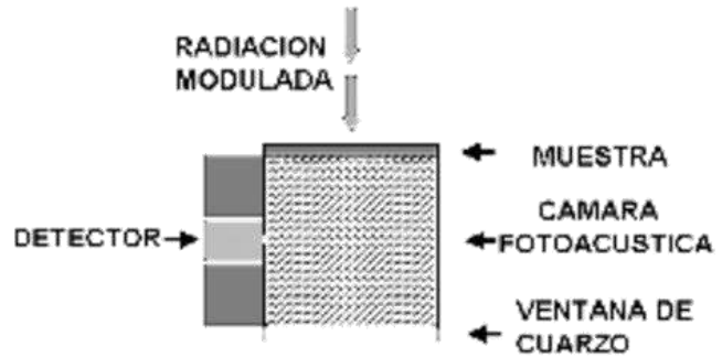
Figura 2. Corte transversal de la CFA en configuración de transmisión de calor.
