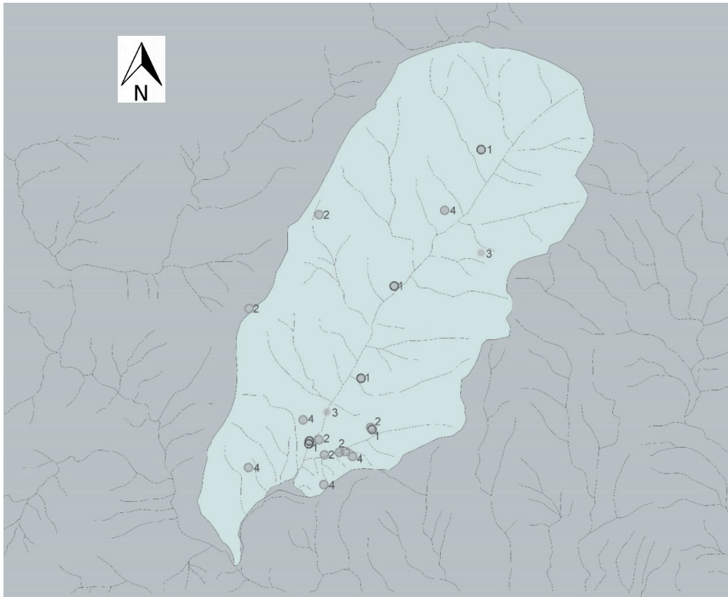
Figura 2. Distribución espacial de los taludes y laderas inestables evaluadas en la microcuenca de la quebrada Cay. RVF: muy alto (1), alto (2), medio (3), bajo (4).
